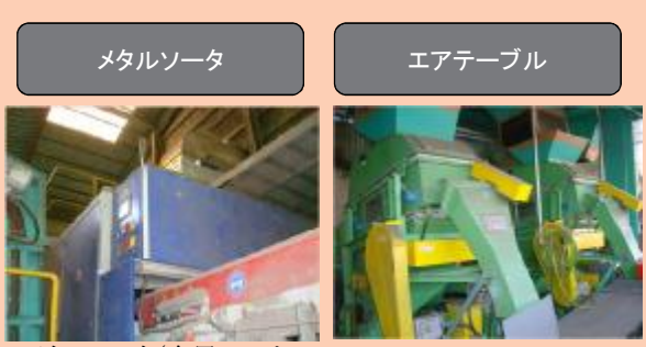
メタルソータ (金属センサーによる選別機) : 有価プラスチックとミックスメタルに分別する装置 エアテーブル (比重選別機) : 金・銀・銅、有価プラスチックに分別する装置
